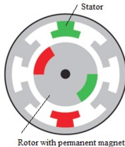
Fig. 2 – BLDC Structure<sup>2</sup>
